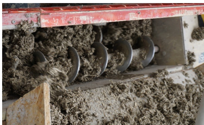
Zwei Schnecken sorgen dafür, dass beide Ansaugrohre kontinuierlich bedient werden.
